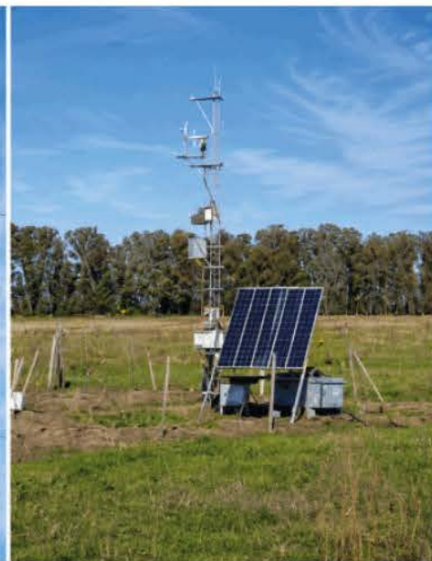
Marconato instaló dos torres con sensores de dióxido de carbono —provistas por el Instituto de Clima y Agua del INTA— una en el campo agrícola y otra en el pastizal.
