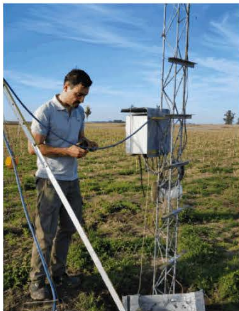
Marconato instaló dos torres con sensores de dióxido de carbono —provistas por el Instituto de Clima y Agua del INTA— una en el campo agrícola y otra en el pastizal.
