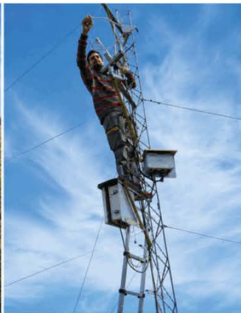
Marconato instaló dos torres con sensores de dióxido de carbono —provistas por el Instituto de Clima y Agua del INTA— una en el campo agrícola y otra en el pastizal.
